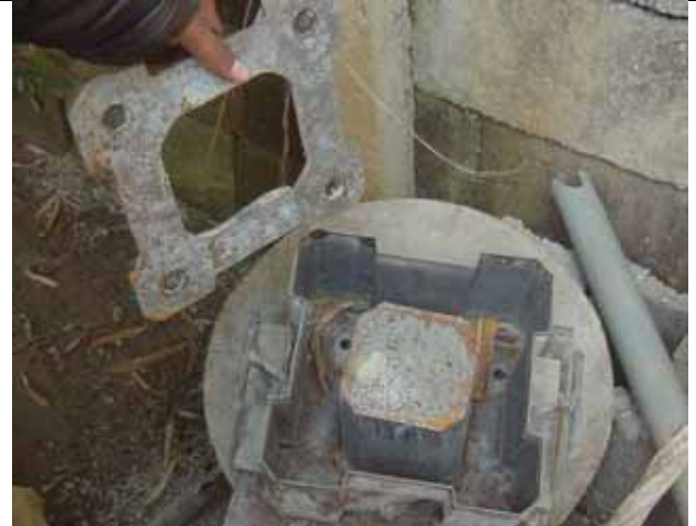
柱用ブロックを製造するためのモールド
