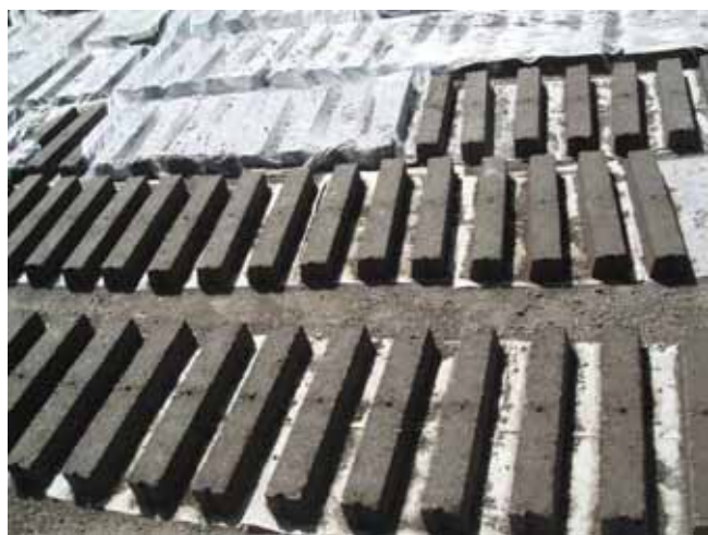
壁用ブロックを干しているところ
