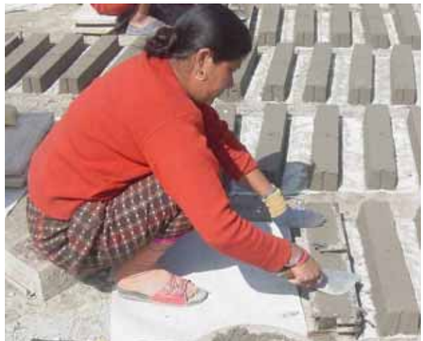
壁用ブロックの製造。セメントを少しずつハンマーで叩きながらモールド(型)に押し込んでいく。黙々と作業を続ける女性らの姿が印象的。
